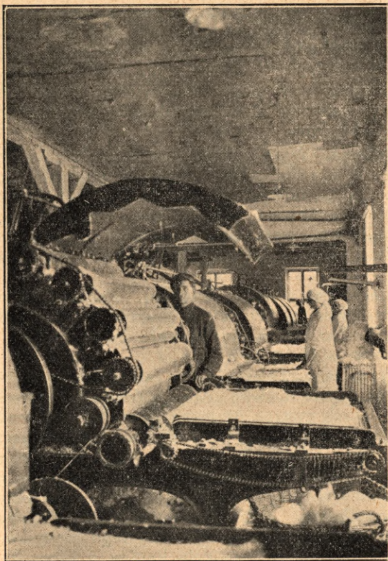
Rys. 155. Fabryka waty hygroskopijnej „Alba” — Nakładanie strzępów waty do zgrzeblenia.
